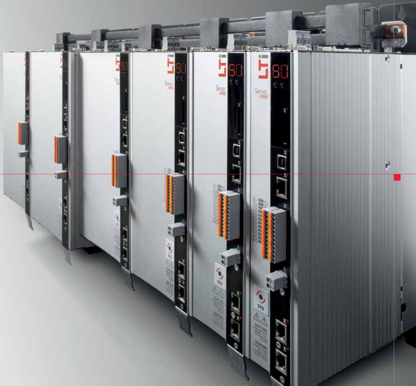
Eine kostenoptimale und platzsparende Variante zur Versorgung der DC-Achsmodule bietet bei geringem Gleichzeitigkeitsfaktor die Versorgung über den Zwischenkreis einer ServoOne-Einzelachse (Shared-DC-System). Die Summenleistung des Zwischenkreises entspricht hier der Leistung des AC-Achsmoduls. Anfallende kinetische Bremsenergie wird über einen gemeinsamen Bremswiderstand in Wärme umgewandelt.
